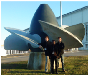
[ Turbine Kaplan d'EDF ]
