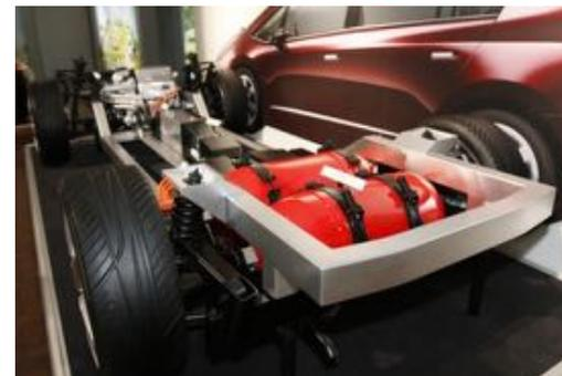
*Réservoir d'hydrogène de la Honda FCX Clarity (350 bar)*
