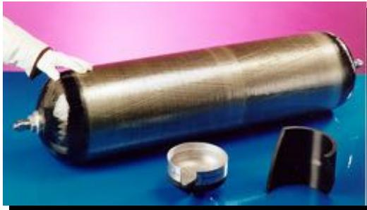
*Réservoir d'hydrogène hyperbar (vessie aluminium + composite)*
