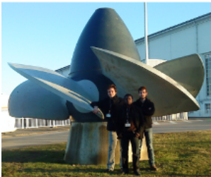
[ Turbine Kaplan d'EDF ]
