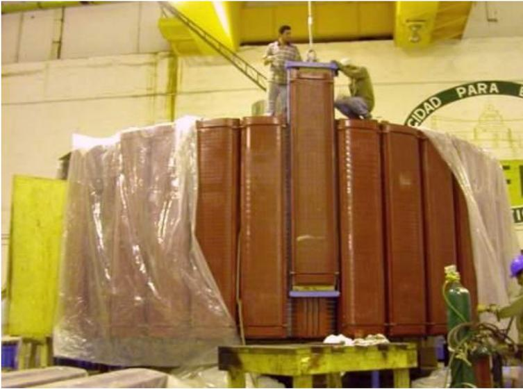
Montage d'un rotor vertical de 345 MVA
